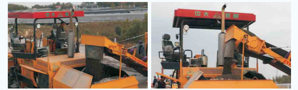
主机料斗防漏料并减少离析的挡板
